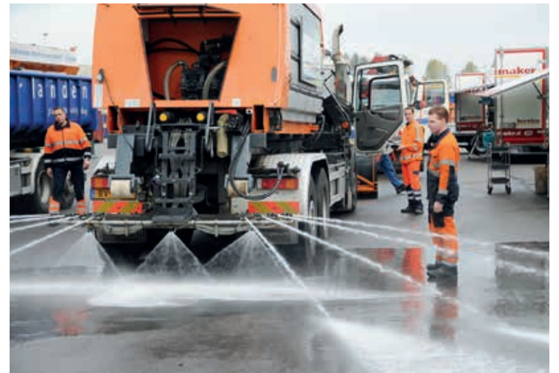
Bij de gladheidsbestrijding wordt onder meer gebruik gemaakt van de zogeheten 'natzoutmethode' en het sproeien met pekewater. Foto: gemeente Haarlemmermeer.
